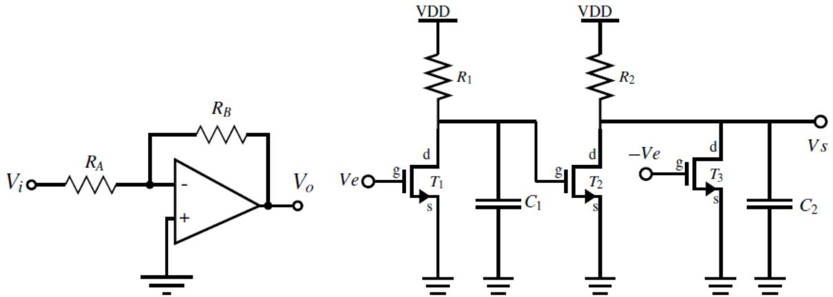
FIGURE 3 – Gauche) Montage amplificateur Droite) Schéma simplifié de l'AOP
