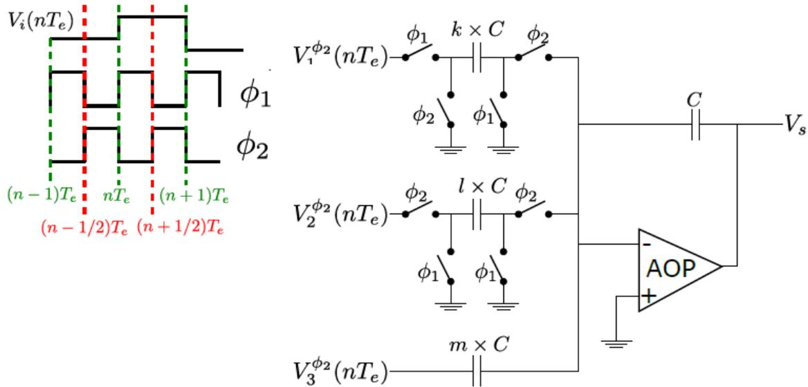
FIGURE 1 – Circuit à capacités commutées
